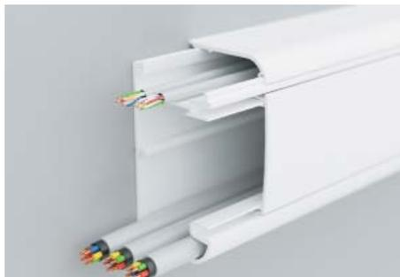
Уникальная конструкция – в коробе 90/2х50 мм (код 09500) имеется встроенный разделитель, создающий 2 независимых отсека с крышками для удобной прокладки различной проводки. Разделитель имеет преперфорацию для перевода кабеля при необходимости из одной секции короба в другую
