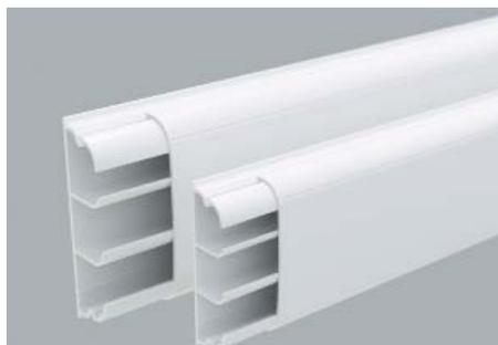
Плнтусные кабельные короба 70x22 мм и 90x25 мм имеют по 2 встроенных разделителя, т. е. у кабель-каналов внутри – 3 секции. Благодаря этому удобно прокладывать кабели
